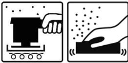
ロックウオッシュプライマーは金属表面と反応して付着性や防錆性の効果が発揮されますので旧塗膜および錆はディスクサンダーなどで完全に除去し、金属面を露出させてください。
