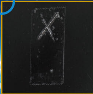
着色層、クリアー層共に剥離なし。 塗装可能
