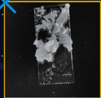
劣化クリアー層剥離 塗装不可
